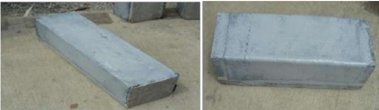
El tejido saturado con el epóxico e imprimado en la superficie de los especímenes de hormigón, se mantuvo en fraguado durante una semana, tiem-
