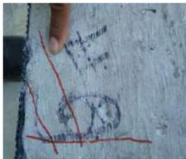
Las vigas con refuerzo paralelo al plano de falla presentaron fallas tempranas por apertura de la fibra sobre la grieta generada, con tensiones mucho menores y rotura del epóxico, el ensayo agrandó las fisuras ya presentes puesto que la orientación del tejido no fue la correcta en este caso; sin embargo, se aprecia un ligero aumento en la resistencia de la viga producto del trabajo conjunto del tejido y el epóxico.
